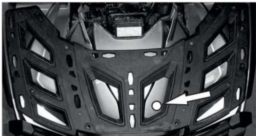
23. Просверлить изнутри отверстие в пластиковом капоте для вывода проводки подключения вентилятора. Подключить вентилятор в штатный разъем
