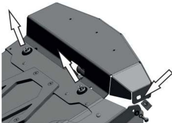
25. Закрепить воздуховоды D63 поз. 4,5,6 на панели поз. 2. Вставить клетьевые гайки M6 поз.34 в панель поз. 2. Открутить на 3-4 оборота верхние винты крепления радиатора к выносу. Завести панель в вынос радиатора. Закрепить панель к выносу винтами M6x20 поз.29 через шайбы 6 поз.38,39. При необходимости уменьшить длину воздуховодов: их длина должна обеспечивать полную регулировку угла наклона выноса радиатора.
